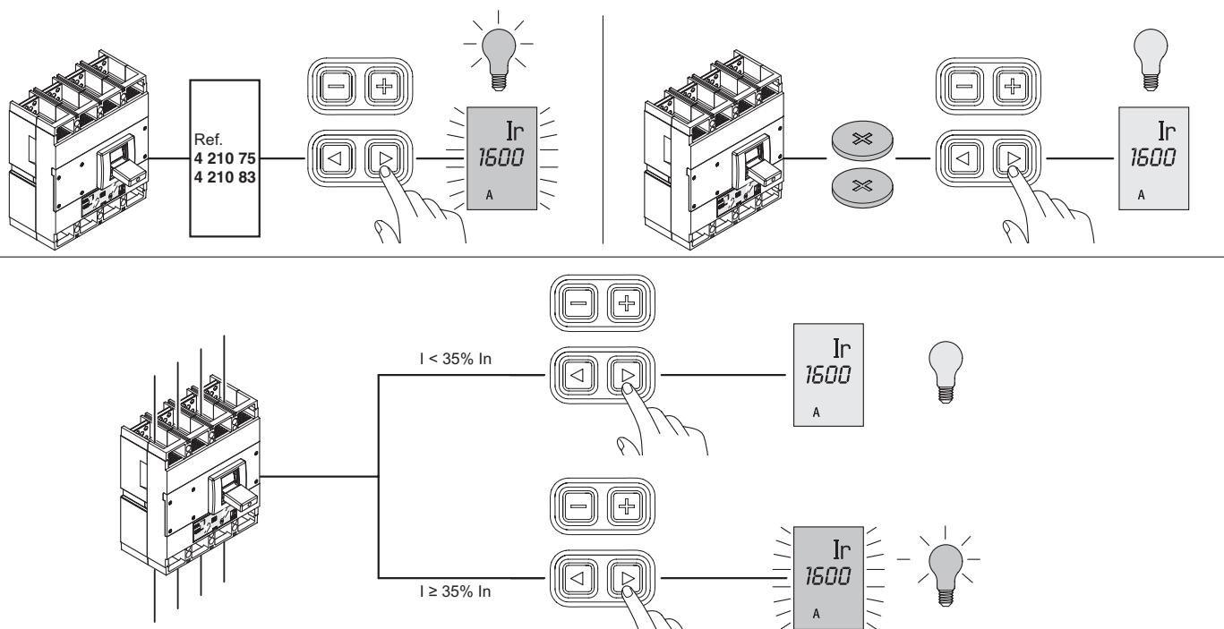
Description des fonctions de protection : Les fonctions de mesure sont activées avec l'alimentation externe de la carte électronique, pour toutes les conditions de fonctionnement à partir de 0A. En mode auto-alimenté, les fonctions de protection listées sont toutes activées, même avec la led verte éteinte. Au cas où le courant contrôlé par l'appareil est proche du seuil d'auto-alimentation, l'unité de protection est toujours active.
