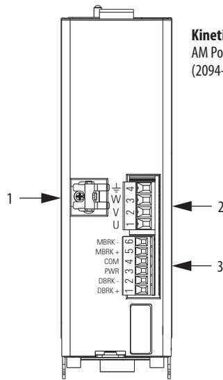
**Kinetix 6200 or Kinetix 6500**
